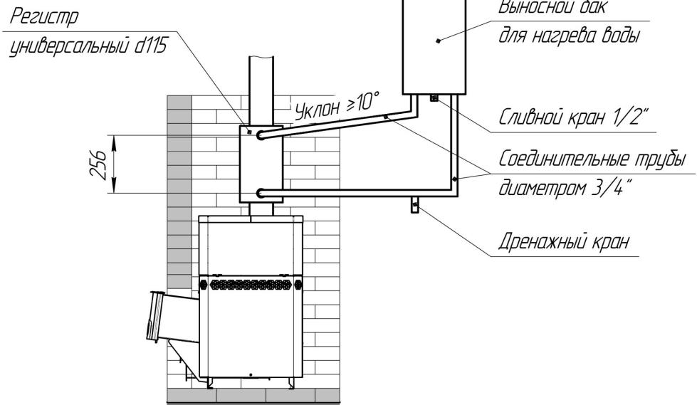
**Рисунок 2 - Подключение бака с универсальным регистром-теплообменником**
