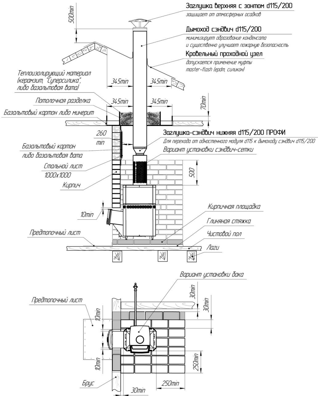
Рисунок 6 - Схема установки печи с кирпичной кладкой
