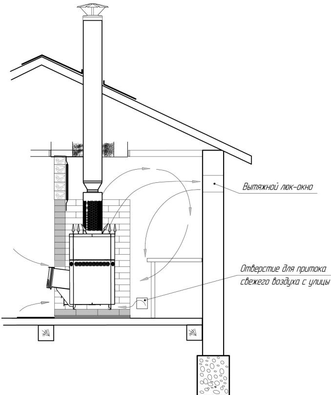
Рисунок 10- Схема воздухообмена в парилке
