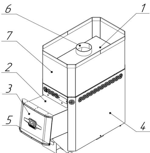
**Рисунок 1а - Конструкция печи-каменки «РУСЬ»**
